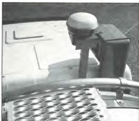
Bovenop de vrachtwagen de kleine 'schotelantenne' die zorgt voor ontvangst en opstraling naar de beide in gebruik zijnde satellieten.
